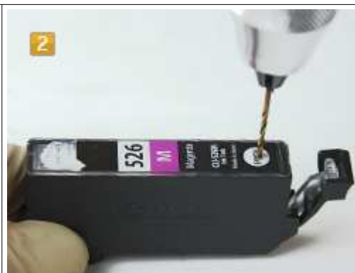
Canon PGI-525, CLI-526 Einfüllöffnung bohren
