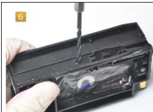
HP 950 Einfüllöffnung bohren
