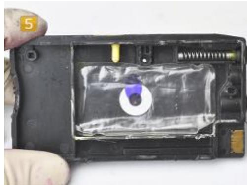
HP 951 Querschnitt mit eingesetztem Verschlussstopfen
