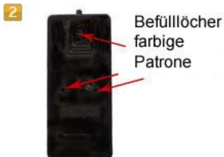
Lexmark 23A, 24A, 36A, 36XLA, 37A, 37XLA Befüllöffnungen bohren schwarze Patrone
